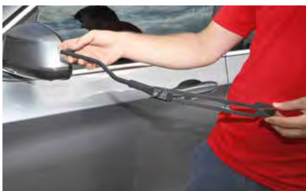
Der Trägerarm des Emuk Spezial passt perfekt auf das Gehäuse des Außenspiegels und ist schnell befestigt.
